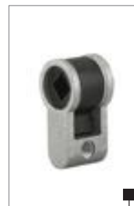
Accessoire disponible : adaptateur à condamnation carré 6 mm pour serrure à encastrer. Il permet de transformer une serrure à cylindre européen en une serrure bec-de-cane à condamnation.
